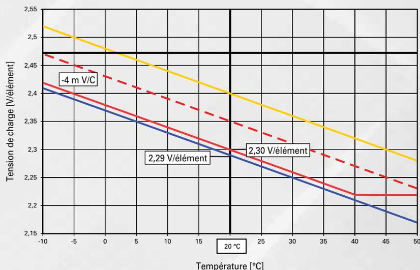
**Tension de charge compensée en température**
