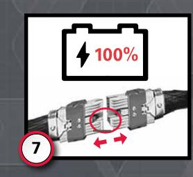
Le chargeur indiquera quand la charge est complète. Débranchez alors la batterie du chargeur.
