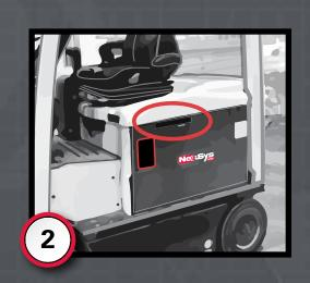
Connectez les câbles du chargeur à la batterie à l'aide de la connectique de charge de batterie dédiée. Ne chargez pas avec un câble reliant la batterie à l'équipement.
