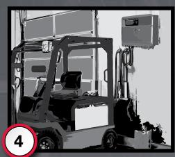
Si la batterie est DÉSACTIVÉE, le chargeur réactive automatiquement la batterie et commence à charger.
