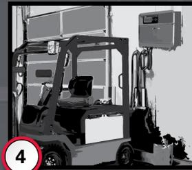
4 Se a bateria estiver DESLIGADA, o carregador acordará a bateria automaticamente e começará a carga.
