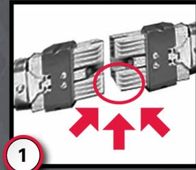
**1** Antes de la conexión, asegúrese de que los cables no estén dañados y de que los conectores no estén contaminados.
