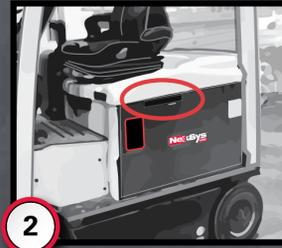
**2** Conecte los cables del cargador a la batería con los conectores de carga específicos. No cargue con el cable que conecta la batería al equipo.
