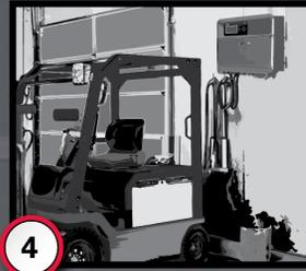
**4** Si la batería está apagada, el cargador la activará automáticamente y empezará a cargarla.
