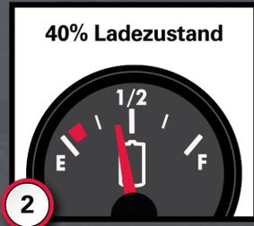
**2** Für eine maximale Lebensdauer der Batterie sollte der Ladezustand der Batterie nie unter 40% fallen.
