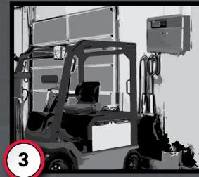
**3** Zwischenladungen erhöhen die Lebensdauer der NexSys<sup>®</sup> TPPL-Batterie. Schließen Sie die Batterie während aller Stillstandszeiten an (wenn das Fahrzeug nicht in Gebrauch ist).
