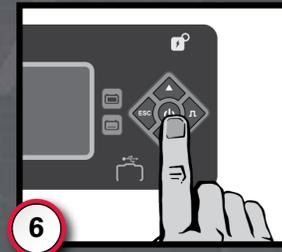
**6** Drücken Sie die STOPP-Taste, bevor Sie die Batterie vom Ladegerät trennen.
