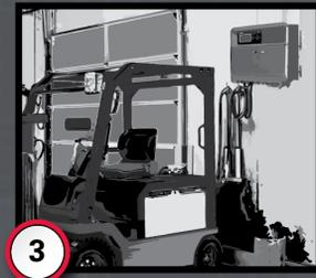
**3** La carga parcial maximiza la vida útil de la batería NexSys<sup>®</sup> TPPL. Enchufe durante todo el tiempo de inactividad (cuando el vehículo no esté en uso).
