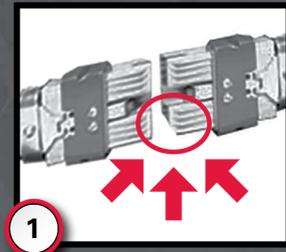
**1** Informe a su supervisor sobre cualquier conector o cable dañado.
