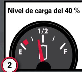
**2** Para maximizar la vida útil de la batería, el nivel de carga no debe ser inferior al 40 %.
