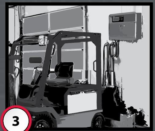
Η ευκαιριακή φόρτιση μεγιστοποιεί τη διάρκεια ζωής της μπαταρίας NexSys<sup>®</sup> TPPL. Συνδέστε τον φορτιστή στις περιόδους αδράνειας (όταν το όχημα δεν χρησιμοποιείται).
