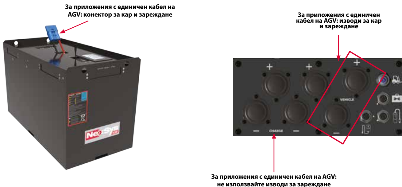
Фигура 4: Приложение с единичен кабел за AGV
